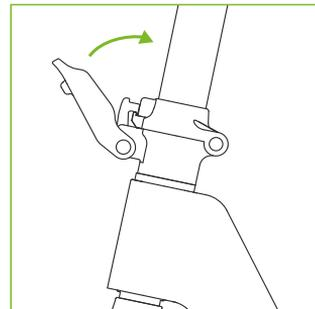
2. Blocca la chiusura ruotando la leva di piegatura in alto verso l'asta.
