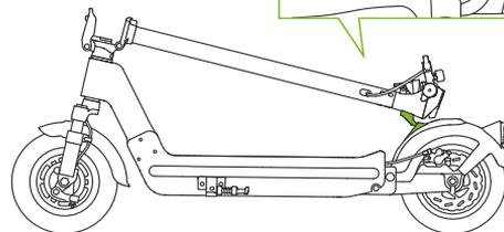
Accertati che l'e-scooter sia spento, sblocca la chiusura premendo in alto il pulsante (a) e ruota la leva di piegatura (b) verso il basso (1), poi muovi l'asta piegandola sul parafango finchè non senti un click (2). Per riaprirlo è necessario premere la fibbia sul parafango posteriore (3).
